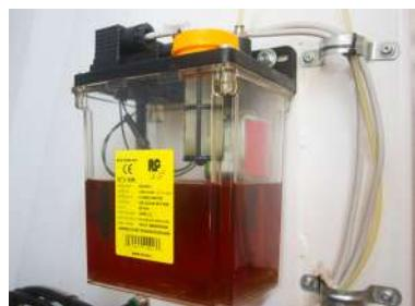
Sistema di lubrificazione assi automatica centralizzata gestita dal CN.
