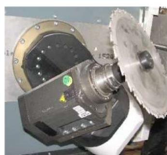
Gruppo fresatore con inclinazione pneumatica da 0 a 22°.
